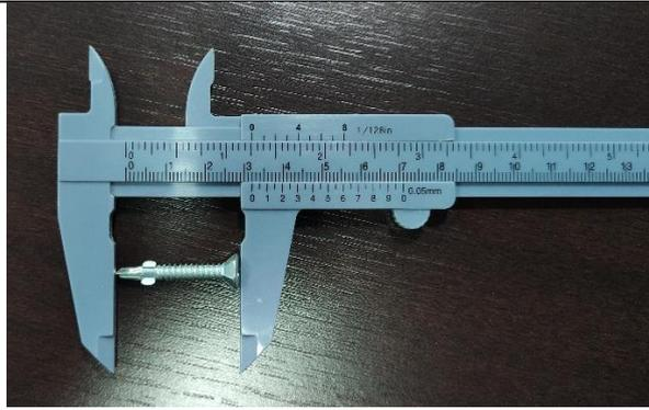
Parafuso auto-brocante utilizado em fixação das chapas em 32 mm
