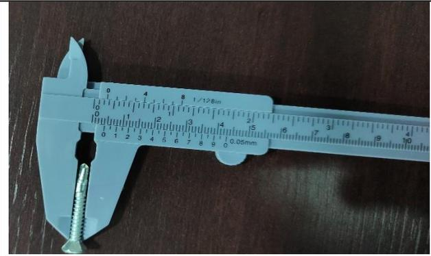
Características dos parafusos utilizados em fixação das chapas em 4 mm de espessura
